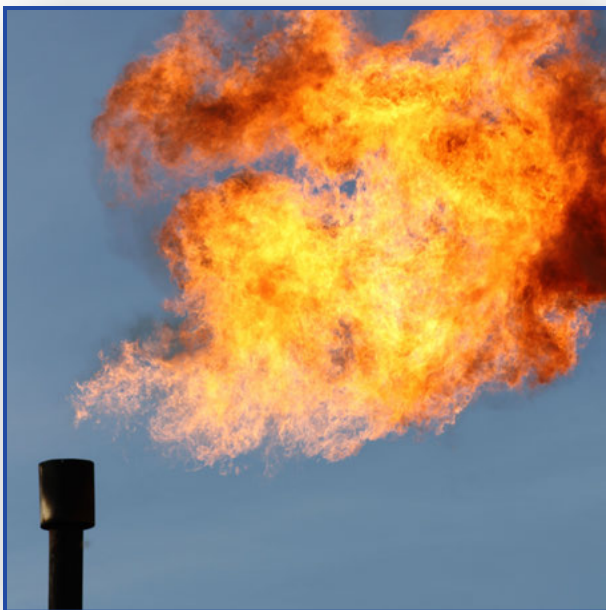
Сжигание попутного нефтяного газа в факеле
