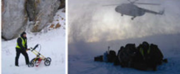
Рабочие моменты Полярной комплексной экспедиции: земные георадиолокационные исследования (слева) и прилет вертолета Ми-8 за одним из полевых отрядов (справа)
