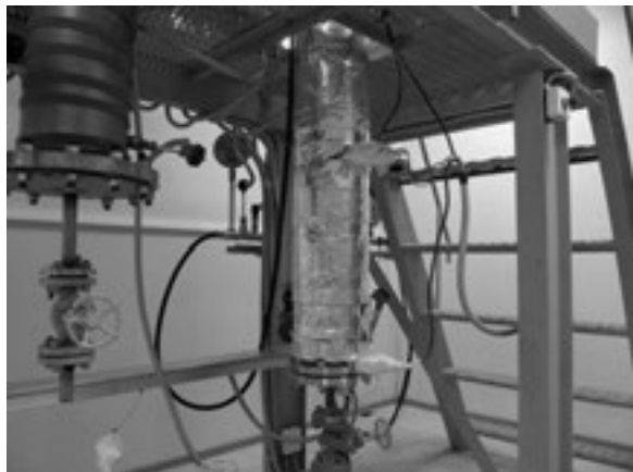
Рис. 6. Колонна термоокисления К-1
