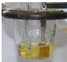
Электрод ИТО с полимером в окисленном состоянии
