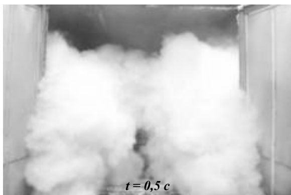
Тушение автомобиля ГАЗ-24 в боксе объемом 70 м 3 и площадью 30 м 2 импульсным порошковым модулем ОПАН-25
