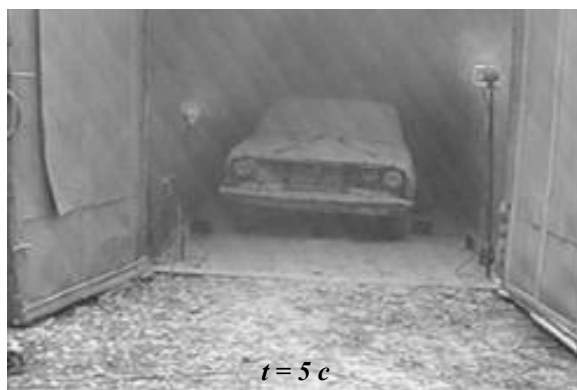
Тушение автомобиля ГАЗ-24 в боксе объемом 70 м 3 и площадью 30 м 2 импульсным порошковым модулем ОПАН-25
