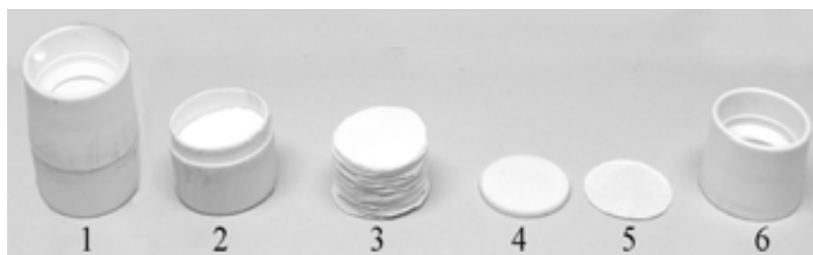
Рис. 4. Приспособление (ячейка) для иммунофльтрационного анализа: 1 – ячейка в сборе, 2 – нижняя часть корпуса, 3 – крупнопористый впитывающий элемент, 4 – полипропиленовая подложка, 5 – твердофазный иммуносорбент, 6 – крышка ячейки с отверстием для внесения реагентов
