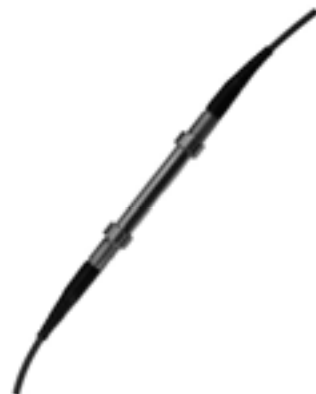
Рис. 5. Датчики деформации: тензорезистивный (а) и опико-волоконный (б)
