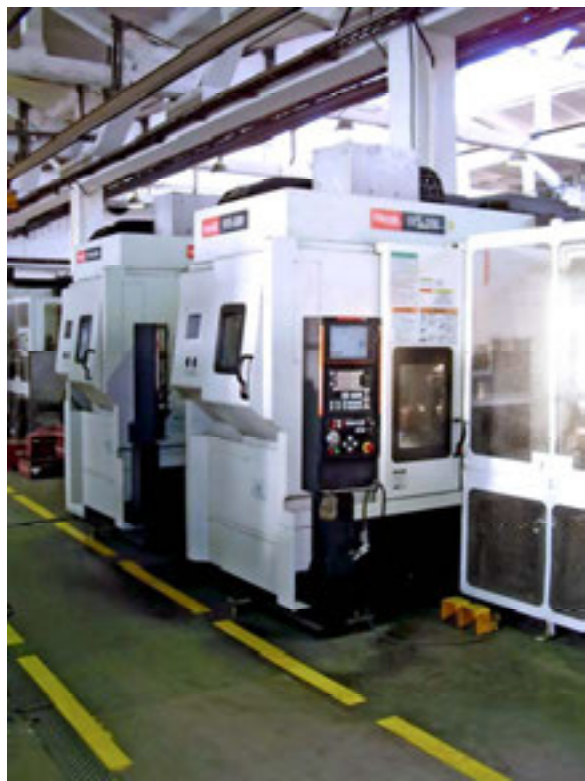
Рис. 14. Роботизированная линия IVS-200 фирмы «Мазак»
