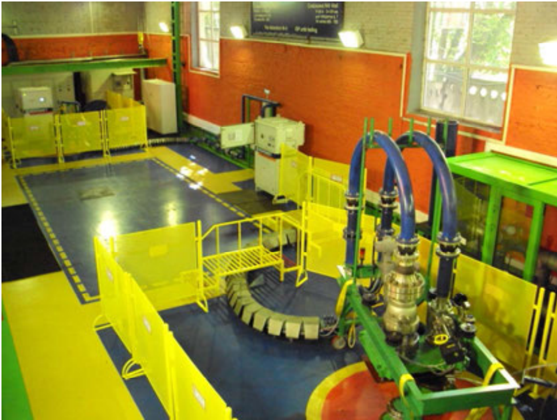
Рис. 5. Стенд-скважина для испытаний погружного оборудования
