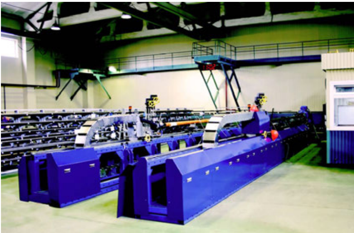
Рис. 6. Стенд для проведения прямо-сдаточных испытаний насосов
