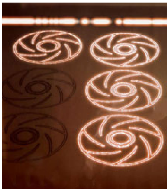
Рис. 8. Работа установки лазерного прототипирования
