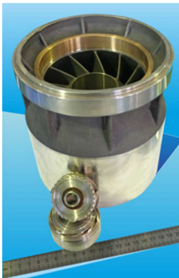
Рис. 9. Сравнительные размеры ступеней насосов
