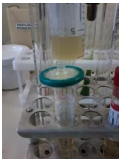
Рис. 1. Стерилизующая фильтрация стерильной насадкой фирмы «Millipore Millex-GP»
